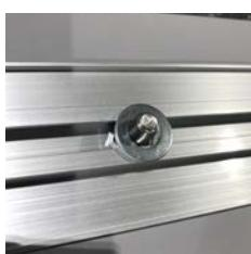
※本体の平リブ側にボルトを入れて平座金を通してから単クランプを設置してください。
